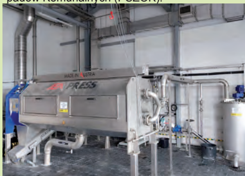
W odwadnianiu osadu pomaga ta potężna prasa
