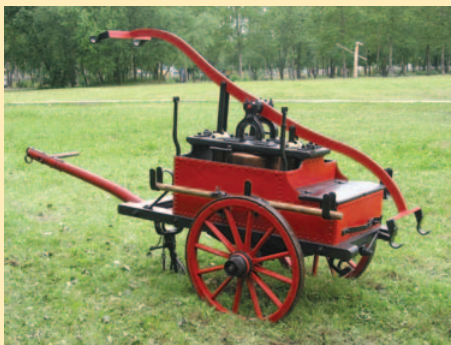
Dwukołowa sikawka ręczna Zdjęcie ze strony cmp.muzeum.com.
