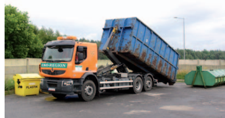
Ustawianie opróżnionego kontenera na terenie PSZOK
